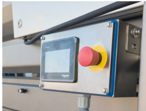
Podesiva brzina vrtnje valjaka selekcijskog stola
