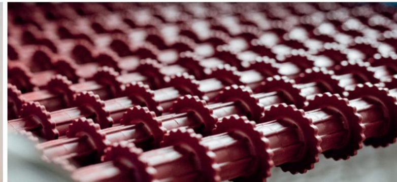
Otvorena i zatvorena sekcija valjaka sa zasebno podesivim razmakom
